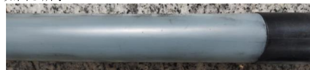
图 5 外半导体断口无应力疏散胶和应力管
