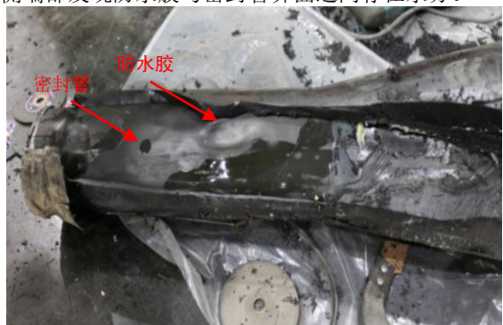
图10 防水胶与密封管界面间存在水分
