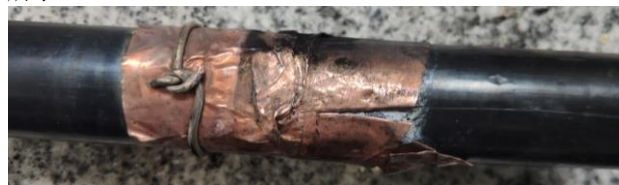
图 4 铜屏蔽断口不齐存在毛刺
