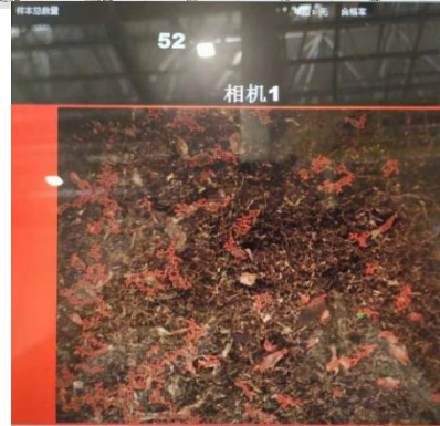
图 8 花片识别测试（花片识别画面，识别的花片红色，红色轮廓显示）
