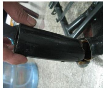
图 3 Q195 材质钢管振动试验断裂缺陷
