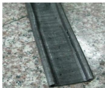
图 1 Q195 材质矩形管压扁开裂缺陷
