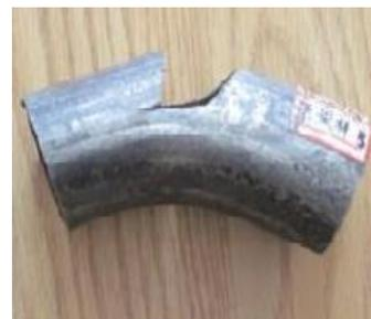
图 2 Q195 材质圆管冷弯开裂缺陷
