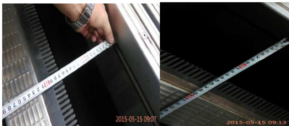
图 1 上行 1 号站台门位置间隙
