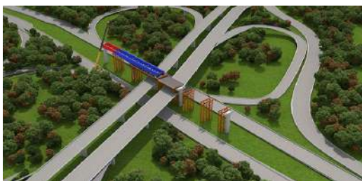
6) 同第一步，小里程方向中跨节段右侧钢轨道梁吊装。
