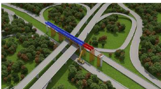
10) 小里程方向边跨节段吊装
