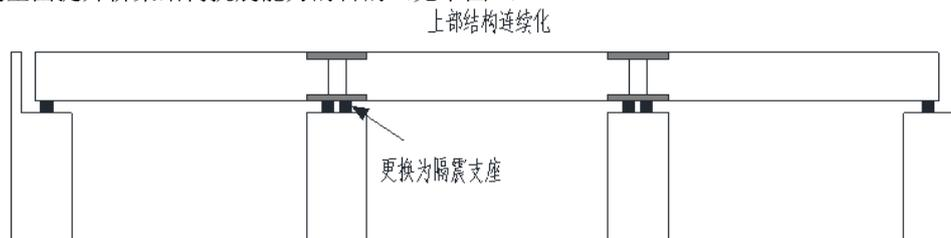
图4 减隔震技术加固示意
