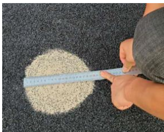
图3 复式精表处构造深度试验
