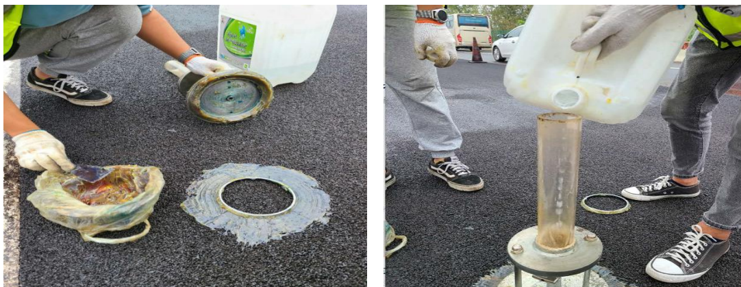
图2 现场渗水试验
