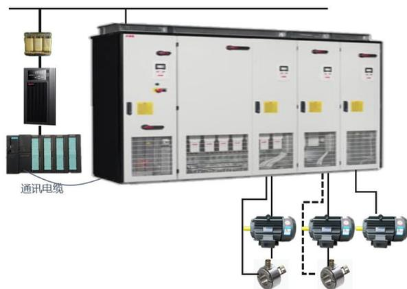
图 6 驱动速度闭环控制
