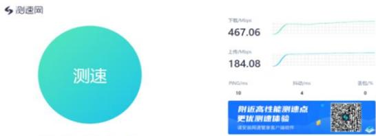
图4 园区 B 经 5G 基站 (SA 模式) 访问 5G 上下行速率结果
