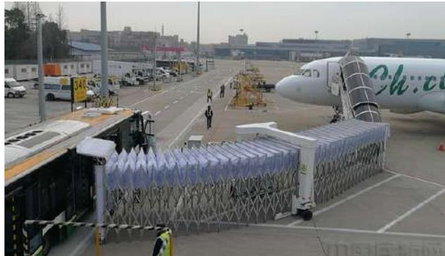
图4 虹桥机场的可移动式远机位登机廊道<sup>[5]</sup>
