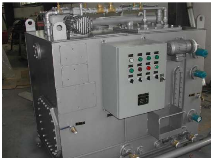
图1 船用污水处理系统设备图
