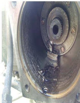
图 3 液压马达转接机匣内残留物
