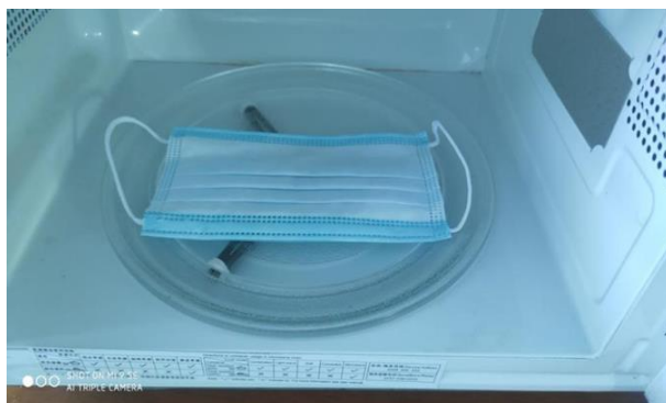
图7 微波照射前的口罩
