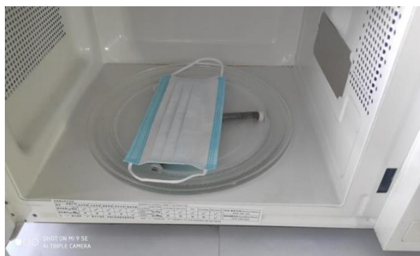
图8 微波照射后的口罩
