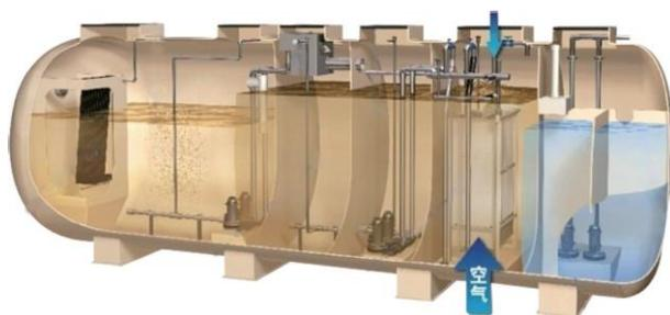
图 2 一体化 MBR 膜污水处理设备
