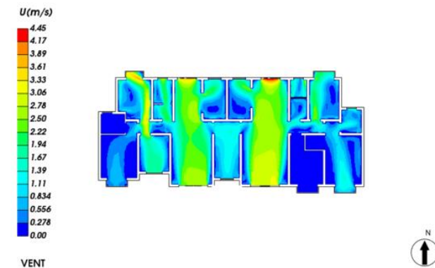
图4 新风系统建筑室内速度分布
