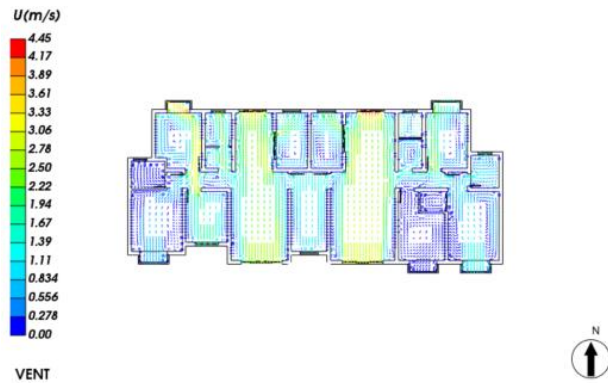
图6 设置新风系统建筑室内风速矢量图
