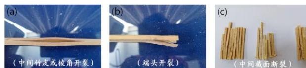
图 7 杆件开裂破坏形态
